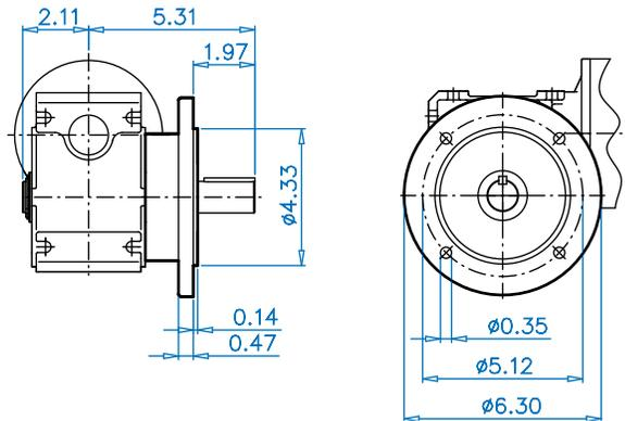
**SK 1SI50 VF (Plug-In Shaft , II Flange)**
