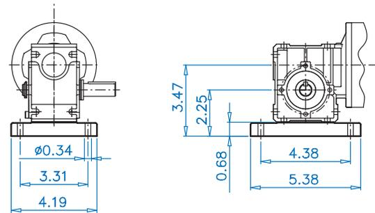
**SK 1SI31 VH (Plug-In Shaft, Shaft Cover)**
