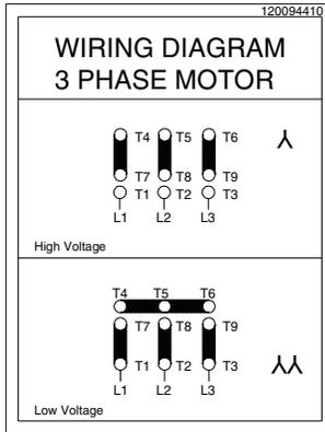
460 / 800V, 60Hz, 3Ø | 230 / 400V, 50Hz, 3Ø
